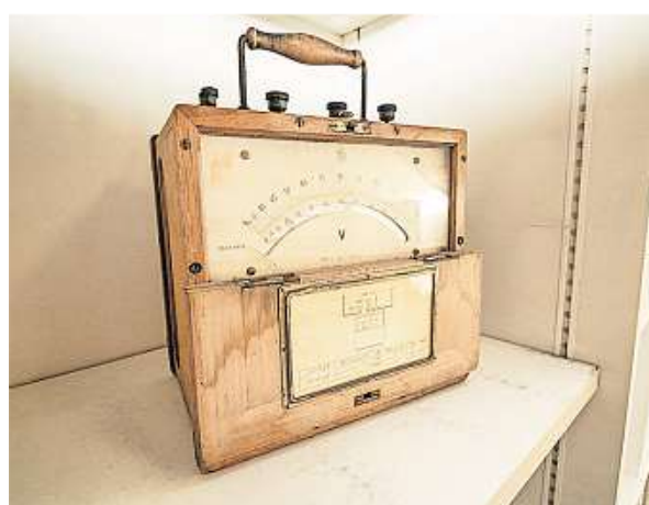
Dieses Foto zeigt ein Messgerät, mit dem die Post einst die Spannung von Leitungen prüfte.
